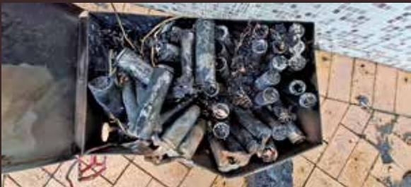
過去不時有電動單車鋰電池短路起火。（資料圖片）
