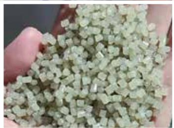
發泡膠經機器打碎再製成膠磚，然後加工成膠珠，膠珠可再造成各種日常塑膠用品。
